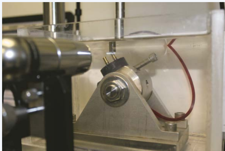
Système de test monté sur une machine de test électrodynamique (avec réserve d'eau)
